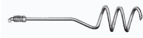
*Se fabrican desde 2" a 6" de diámetro exterior; hecha de acero de varilla, es ideal para usarla como la primera herramienta al iniciar el trabajo. Debido al diámetro de la sección de la barra es más fácil entrar en una masa de raíces u otra obstrucción más sólida. Si aparece agua en la línea es que esta fluyendo de la perforación que la herramienta hizo en la obstrucción.*
