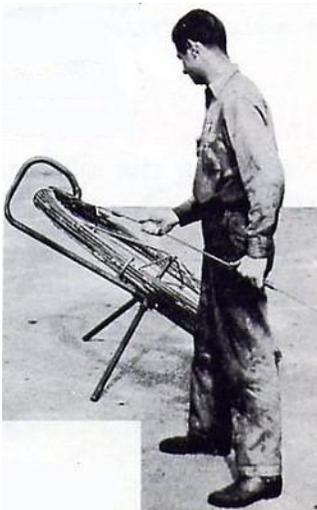
*El Carrete puede almacenar convenientemente 122 metros de Varillas. Nosotros podemos proveer un atril o base para apoyar el Carrete al suelo, o el mismo puede ser colocado en nuestro Trailer, o en la parte superior o lateral de un camión de limpieza de alcantarillas. El uso del Carrete ahorra una gran cantidad de tiempo.*
