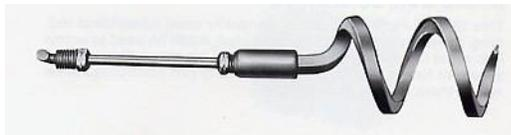
*Se fabrican desde 3" a 12" de diámetro de tubería. Hecho de barra de sección cuadrada de alta calidad y de acero especialmente endurecido. El filo marcado del tirabuzón es como una hoja que corta las raíces u otros objetos cuando las Varillas están siendo jaladas hacia atrás.*
